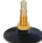
Válvula c/ base de borracha p/ câmaras de ar trator tipo ar/água
